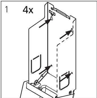
Montage mit 4 Schrauben und Dübeln.
